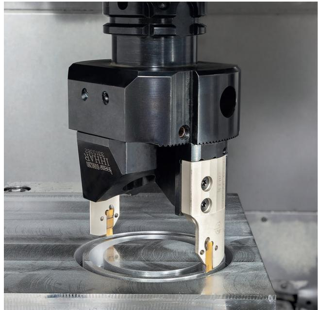
Iscars einstellbares Bohrkronen-System für axiale Einstiche und Kernbohrungen ist modular aufgebaut. Seine Besonderheit ist eine justierbare Verzahnung © Iscar
